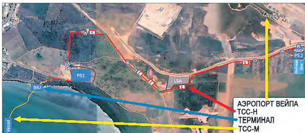
*Трасса трубопроводов ТСС-Н и ТСС-М*
