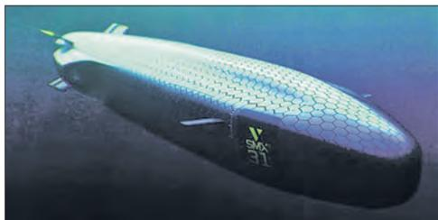
совой части для уменьшения сопротивления при движении, крыльчатки водометных движителей находятся в кожухах. Длина подлодки 80 м, диаметр корпуса
