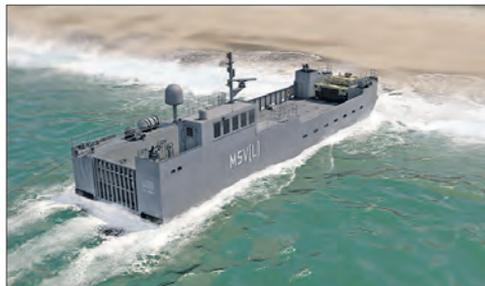
в течение десяти лет прототипа и дополнительно до 35 катеров, которые должны заменить суда типа LCM-8, состоящие на вооружении со времен войны во Вьетнаме. Длина MSV(L) составляет 35,6 м, скорость до 21 уз (30 уз – без груза), дальность плавания – 360 морских миль при полной загрузке. Экипаж – 8 человек. Катер предназначен для перевозки до 82 т полезной нагрузки.
