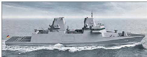
который должны передать ВМС в 2028 году. По информации министра обороны Б. Писториуса, планируется увеличить заказ на корабли этого класса с четырех до шести единиц. Водоизмещение фрегата составит 10 550 т, длина корпуса 166 м, ширина 21,7 м, максимальная скорость хода 26 уз, дальность плавания свыше 4 000 морских миль, экипаж 114 человек. На борту могут размещаться два вертолета NH-90 «Си Тайгер» и беспилотник вертолетного типа.
