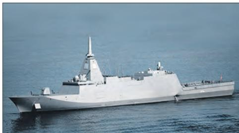
штаб-квартирой в военно-морской базе Майдзурю. Еще 12 фрегатов построят по новому проекту, разработка которого продолжается. Полное водоизмещение фрегата составляет около 5 500 т, длина 132,5 м, ширина 16,3 м, максимальная скорость хода 30 уз. На борту сможет базироваться один многоцелевой вертолет, а также подводные дистанционно управляемые и автономные аппараты для ведения противоминной борьбы.
