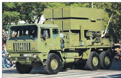
РЛС этого комплекса может сопровождать до 80 целей в радиусе 75 км. Установка имеет шесть пусковых контейнеров с ЗУР AIM-120С-5, способных поражать воздушные цели на дальности от 2,5 до 25 км и высотах до 10 км.
