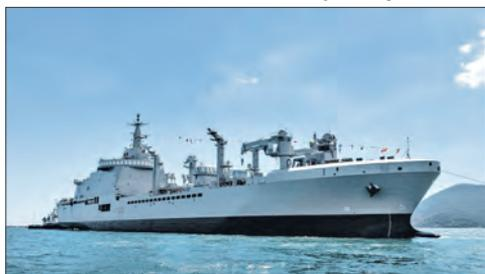
Как сообщает издание «Нейвал ньюс», в 2022 году был введен в строй головной корабль «Вулкан», в 2025-м — будет передан заказчику второй — «Атланту», в 2027-м — последний. Водоизмещение судна составляет 27 200 т, длина 193 м, ширина 27,2 м, скорость до 20 уз, дальность плавания 7 000 миль, автономность 30 сут. Общая масса перевозимых грузов — 15 500 т.
